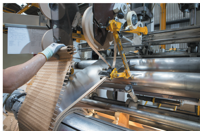
Обмотка НН, изготавливаемая из металлической фольги
