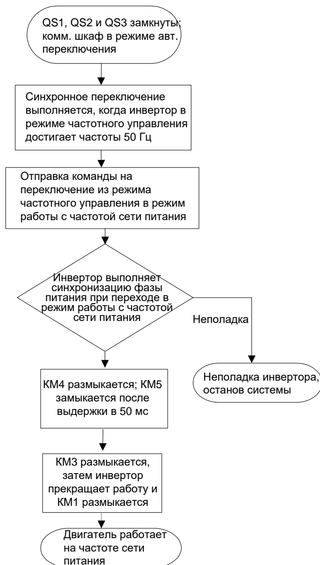
Рис. 6.5 Блок-схема переключения от частотного управления в режим частоты сети питания
