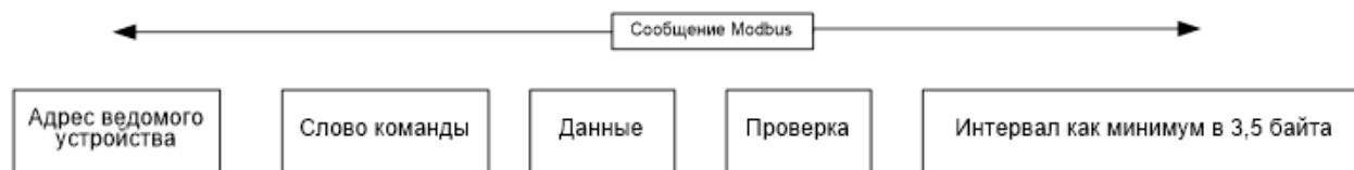
Рис. В.2 Структура сообщения в режиме RTU
