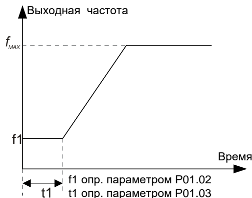
Рис. 5.3 Характеристика непосредственного запуска
