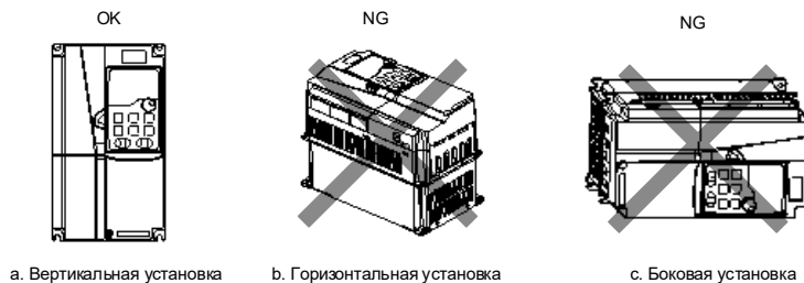
Рисунок 4-1 Направление монтажа преобразователя частоты
