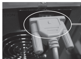
9-контактный кабель связи
