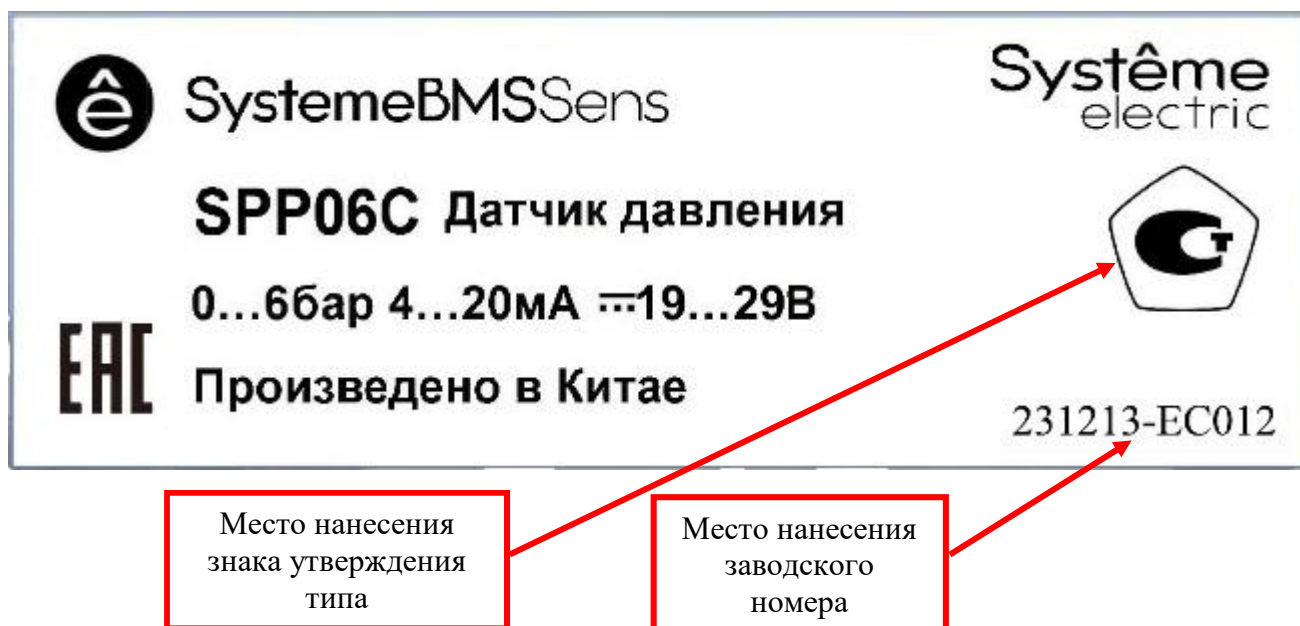
Рисунок 2 – Общий вид маркировки с местами на нанесения знака утверждения типа и заводского номера
