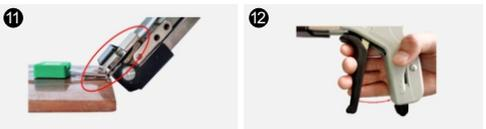
11 Вставьте выступающий конец ленты в приемную часть инструмента под углом 30-60 градусов относительно шины;
