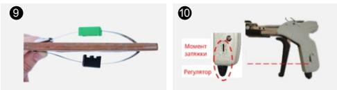
9 После этого отцентрируйте положение датчика относительно шины и слегка загните вверх выступающий конец ленты;
