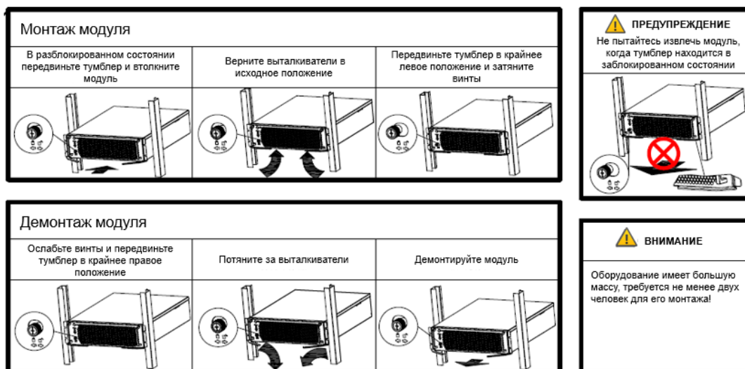
Рис. 4.2.4 Инструкция по монтажу/демонтажу силового модуля
