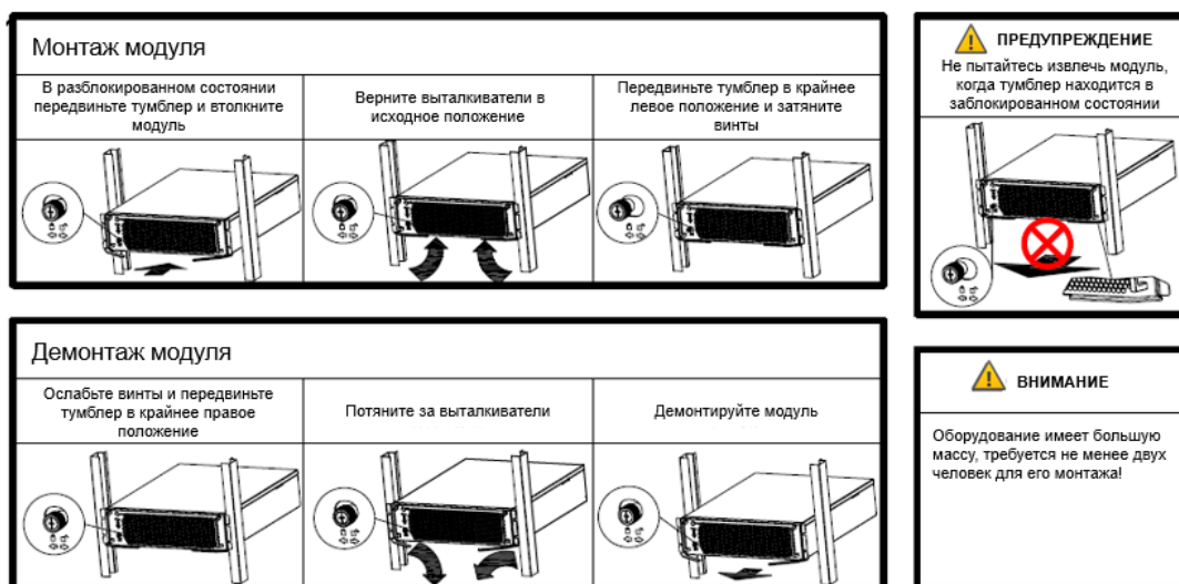
Рис. 4.3.4 Инструкция по монтажу/демонтажу модуля статического байпаса
