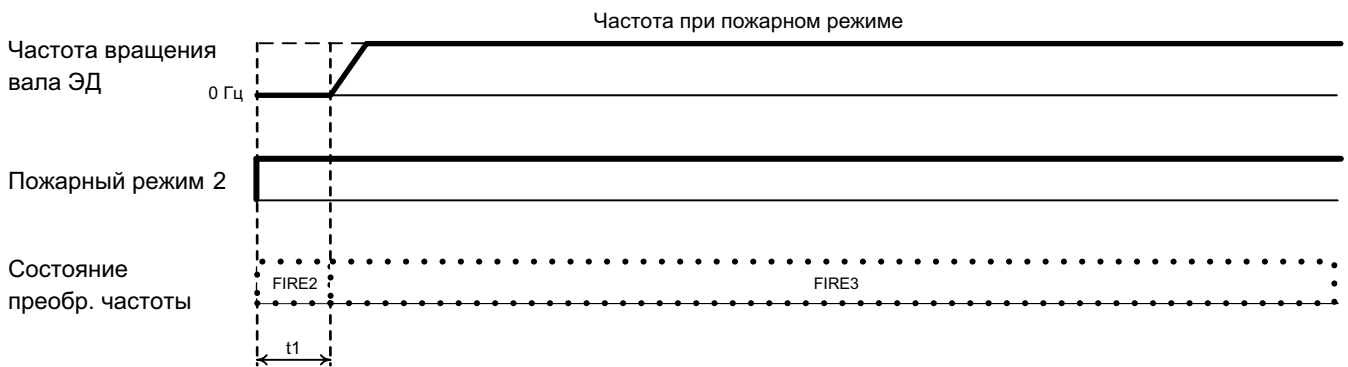
Рис 1.4 – Проверка целостности кабеля при настройке преобразователя частоты на пожарный режим 2
