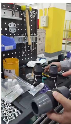
Рис. 24. Смазка внутренних шинных втулок
