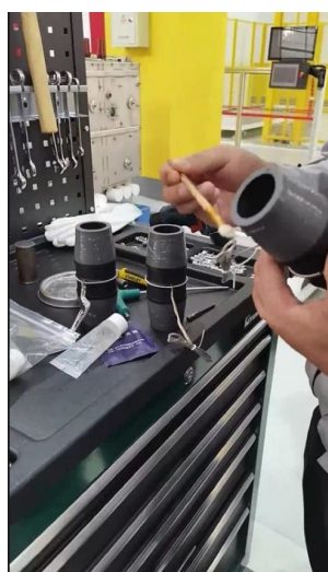
Рис. 24. Смазка внутренних шинных втулок
