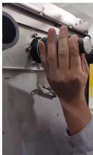
Рисунок 28. Установка втулок в штатное место
