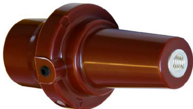
Рис. 32. Кабельный проходной изолятор конической формы, тип, интерфейса-«С» с болтовым присоединением M16, In = 630 A (1250 A)
