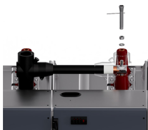
Рис. 15. Затяжка шпилек к верхним проходным изоляторам
