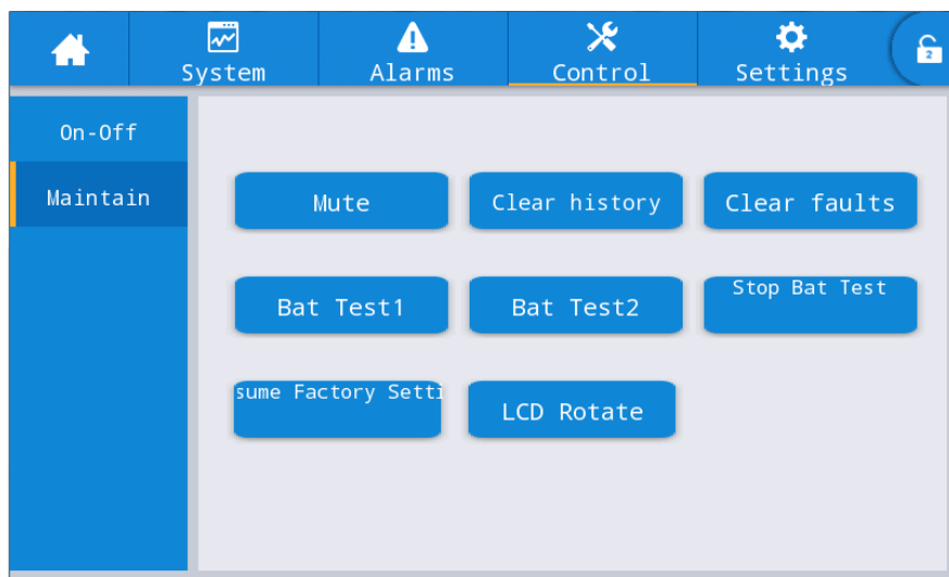
Рисунок 12-3. Техническое обслуживание батареи
