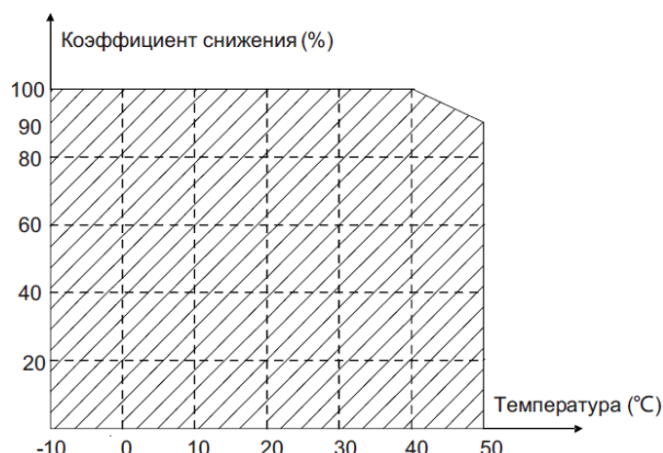
Рис.№2. Снижение выходных характеристик в зависимости от температуры окружающей среды
