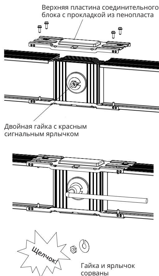
Рис. 8. Установка соединительного блока шинопровода
