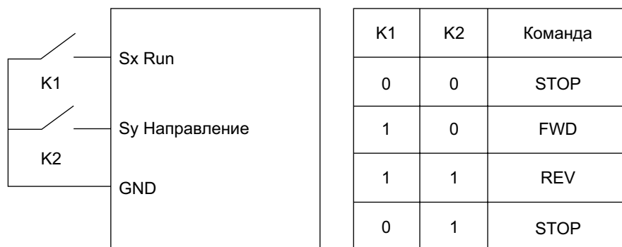
Рисунок 4-5 Двухпроводное управление тип 2
