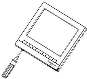
2. Снимите переднюю панель термостата.
